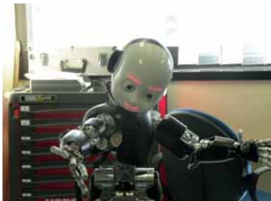
I-cub muove la testa e gli occhi autonomamente. Le mani sono in grado di manipolare gli oggetti e sono funzionali alle attività cognitive.
